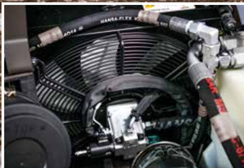
Der Motorlüfter reduziert Emissionen und den Kraftstoffverbrauch.
