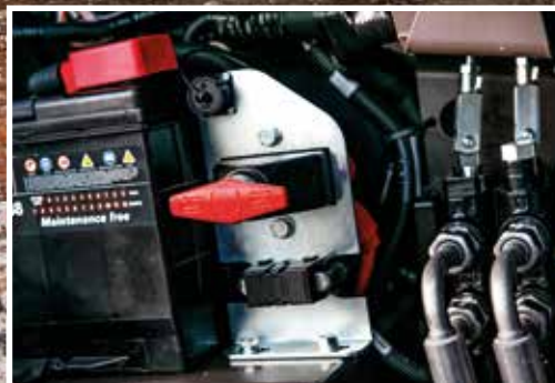
Batterietrennschalter für einfache Wartung.
